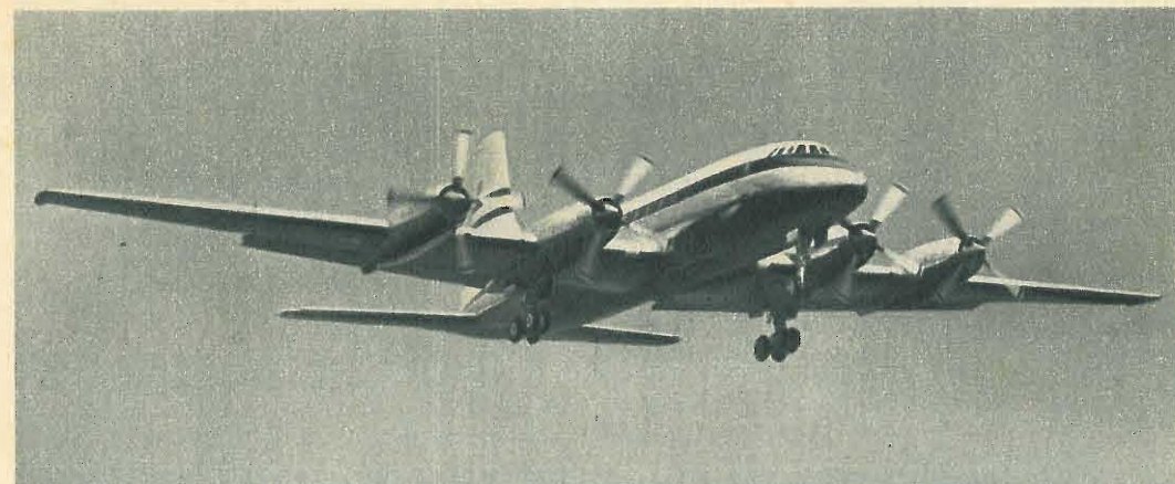
IL BRISTOL BRITANNIA al suo primo volo (16 agosto 1952). Ordinato in 25 esemplari dalla B.O.A.C., è munito di quattro turbopropulsori Bristol Proteus di 3780 cav di potenza equivalente.
