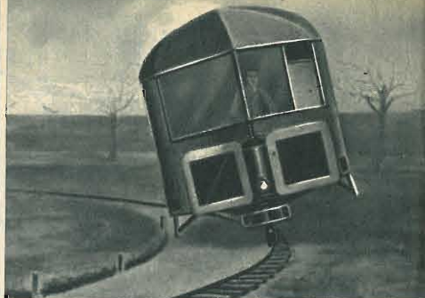
lota lascia i comandi, l'apparecchio si muove sotto il controllo di un pilota automatico giroscopico. A destra, la vettura ferroviaria monorotaia Brennan la cui stabilità veniva assicurata da due giroscopi posti da ciascun lato dell'asse longitudinale.
