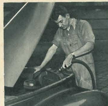
● Vuotate e pulite il radiatore e la camicia del monoblocco...
