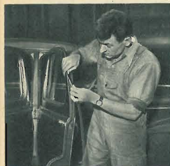
● Verifica delle guarnizioni per la buona tenuta della carrozzeria.
